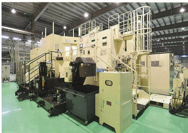
製造の主力である5軸マシニングセンター
